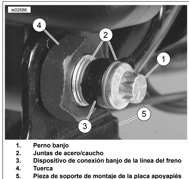
Figura 3. Montaje del depósito del freno trasero
