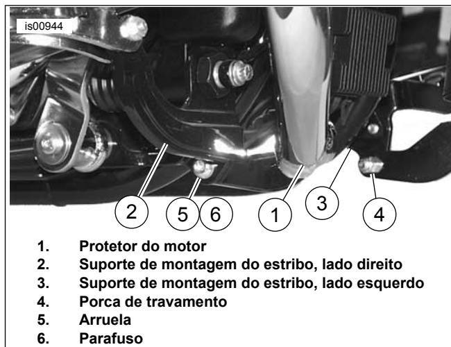
Figura 3. Montagem inferior do protetor do motor (vista do lado direito)
