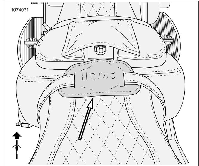
Figura 1. Cubierta de la perilla del ajustador instalada
