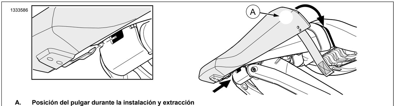
Figura 1. Contenido del kit: Capota de la sección trasera de fibra de carbono
