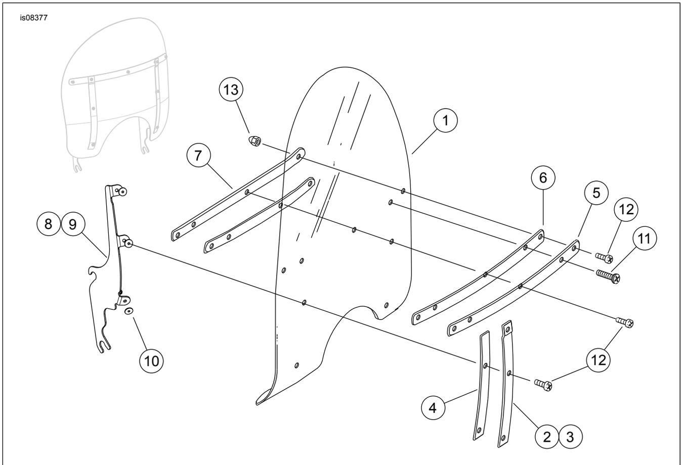
Figura 1. Contenido del kit: Parabrisas (típico)
