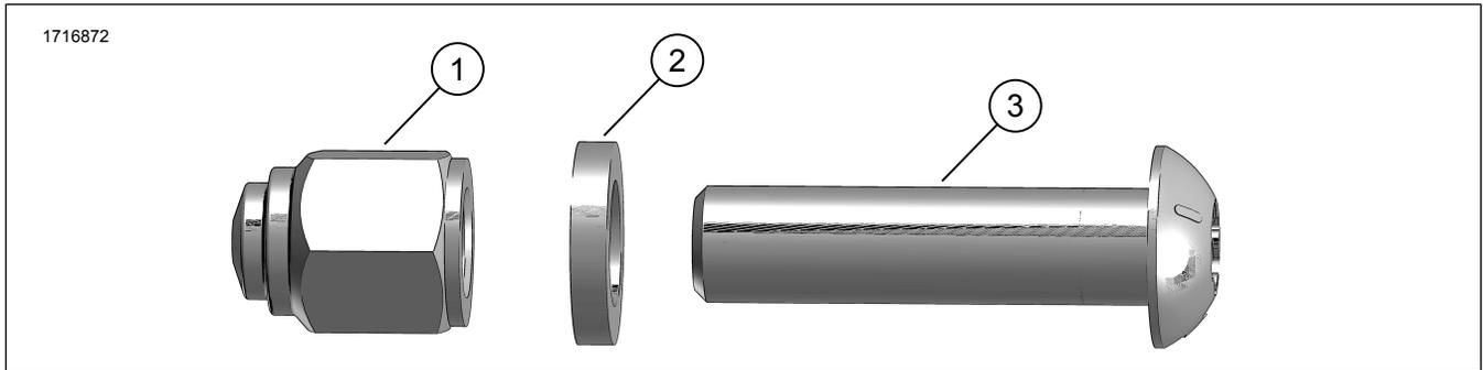
Figura 1. Contenido del kit: Kit de tornillo del taco apoyapiés
