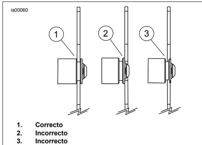
Figura 2. Enganche de la muesca de la pieza vertical en el punto de acoplamiento
