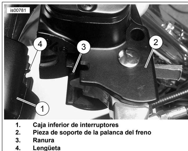
**Figura 13. Ajuste de la palanca/bomba del freno en la caja inferior de interruptores del manillar derecho**
