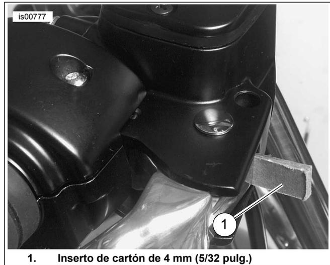
**Figura 2. Palanca del freno/inserto de cartón de la pieza de soporte de la palanca**
