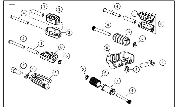
Abbildung 1. Schaltstangenzapfensatz
