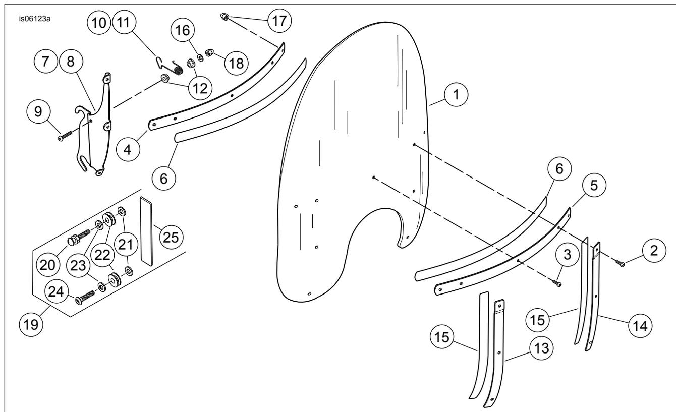
Abbildung 2. Ersatzteile für den Windschutzscheiben-Satz
