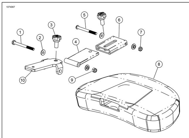
Abbildung 3. Fahrerrückenlehne-Komponenten
