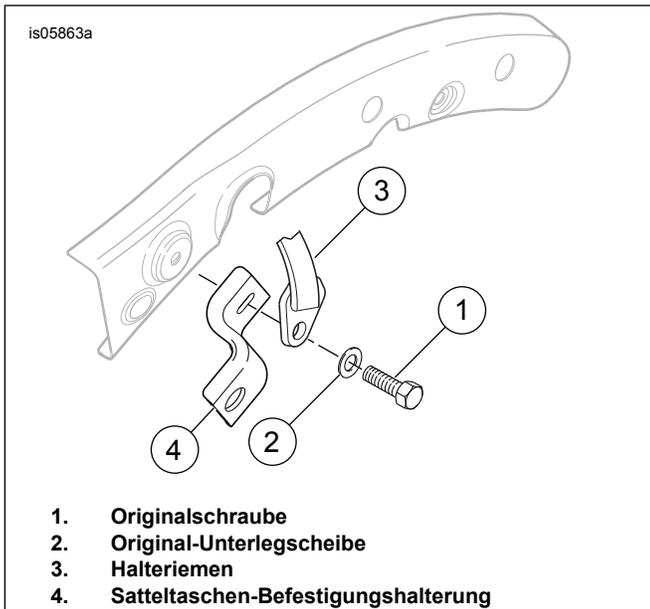
**Abbildung 1. Halteriemen aus- und einbauen**
