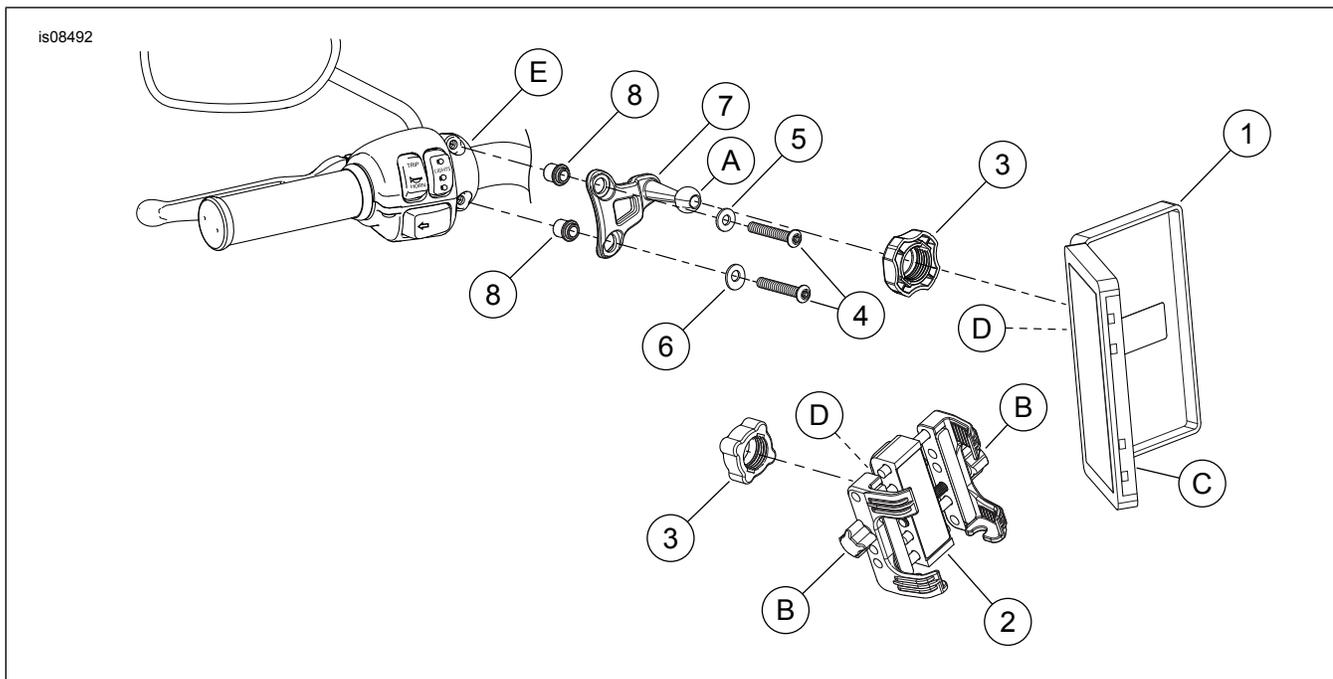
Abbildung 1. Ersatzteile: Smartphone-Befestigungssatz
