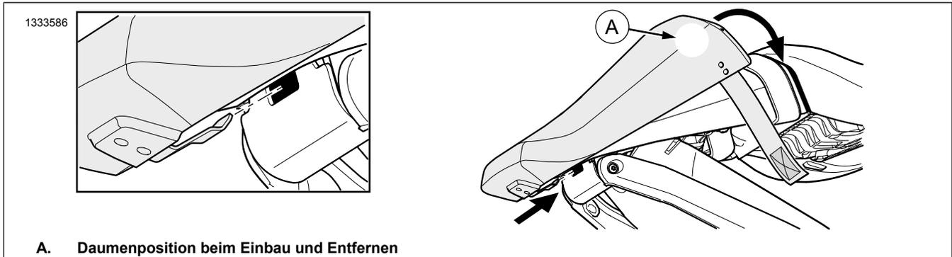
Abbildung 1. Inhalt des Satzes: Sitzhaube aus Kohlefaser am Heckabschnitt
