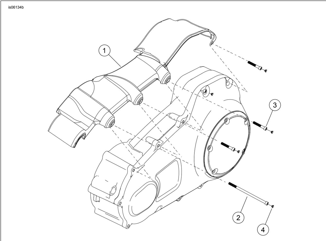
**Abbildung 2. Ersatzteile: Verchromter innerer Primärkettengehäusedeckel**
