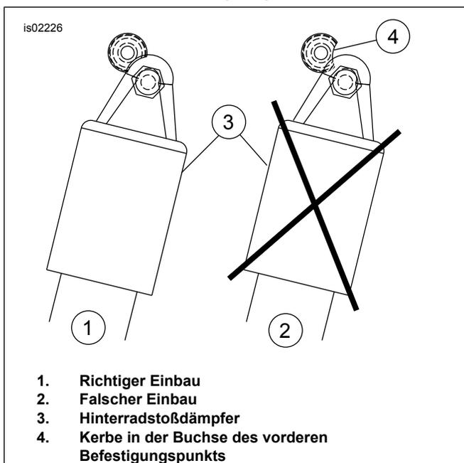
Abbildung 4. Position der Kerbe des vorderen Befestigungspunkts
