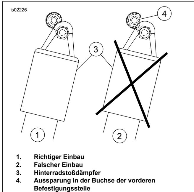
**Abbildung 4. Position der Aussparung der vorderen Befestigungsstelle**
