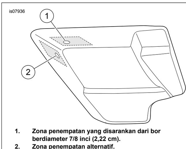
1. Zona penempatan yang disarankan dari bor berdiameter 7/8 inci (2,22 cm).
