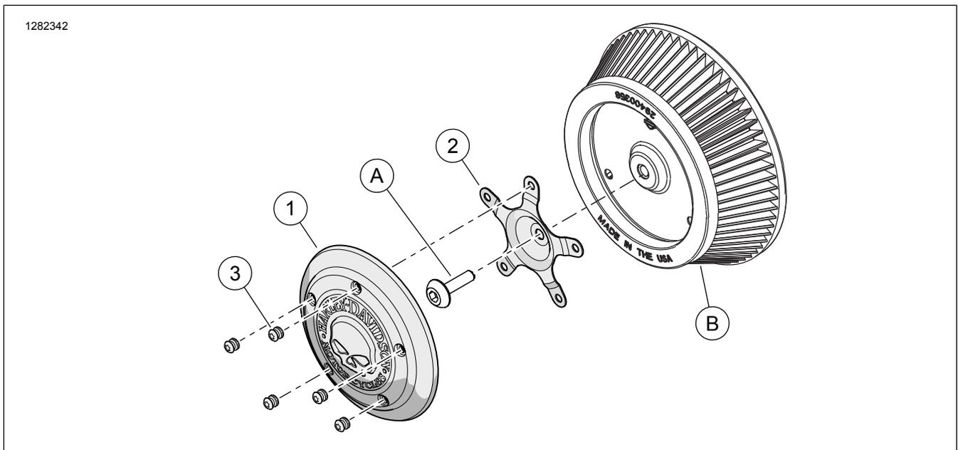
Figure 1. Contenu du kit : Cache-filtre à air
