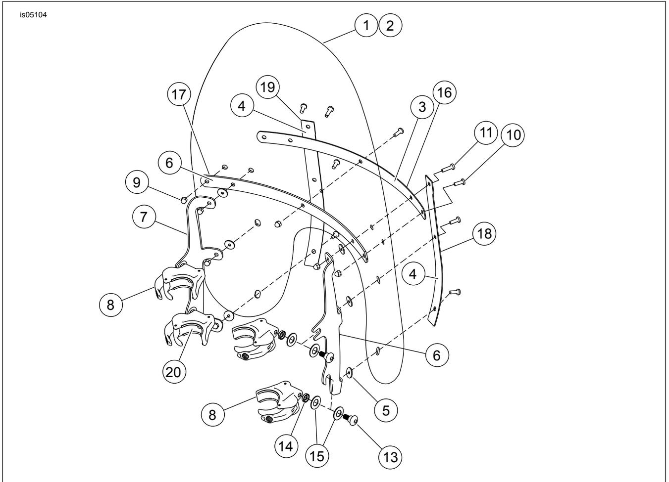
**Figure 7. Contenu du kit : Kits de pare-brise à déconnexion rapide (57338-08, 57340-08, 58617-09, 58630-09)**
