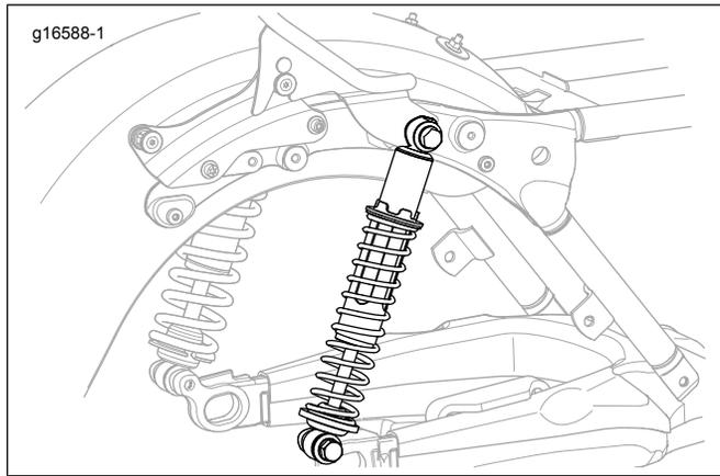
Figure 2. Orientation de l'amortisseur avec pièces amovibles P&A
