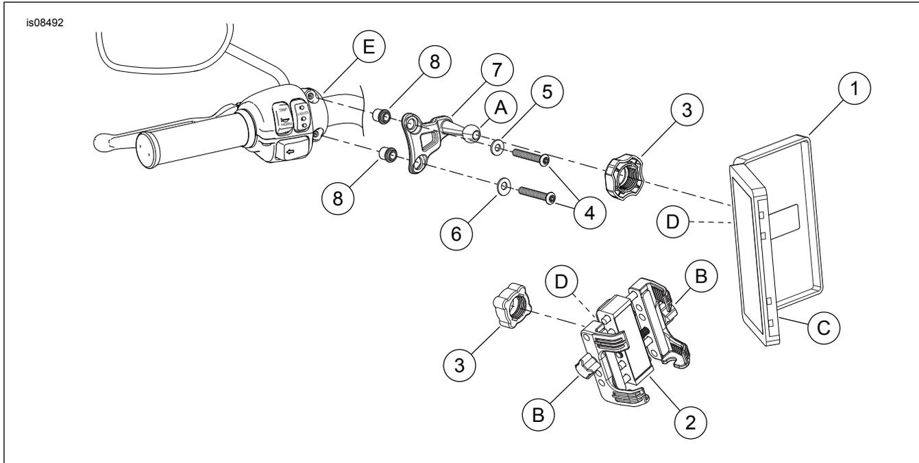
Figure 1. Pièces de rechange : kit de montage de smartphone
