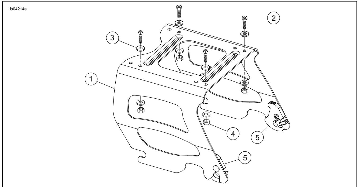
Figure 4. Pièces de rechange : Kit de porte-bagages de Tour-Pak Solo H-D Detachables
