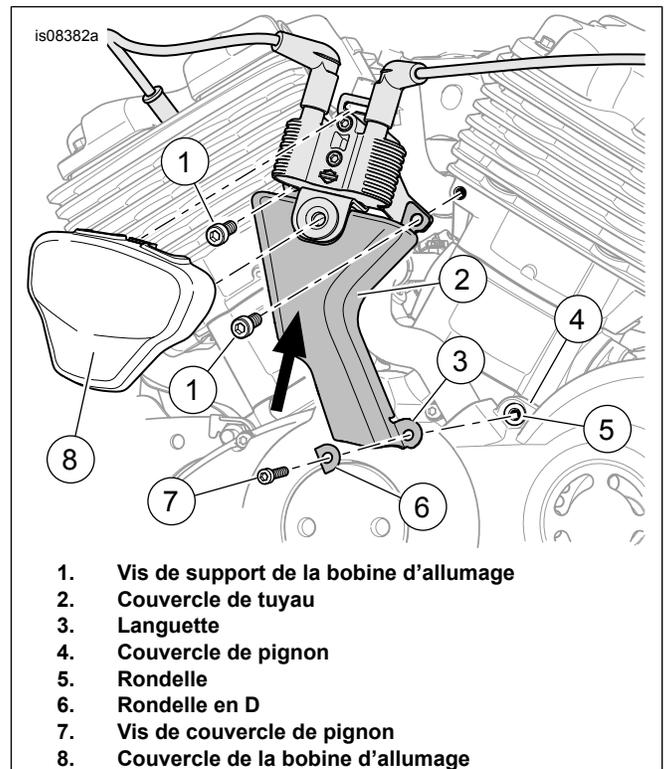
Figure 1. Couvercle de tuyau
