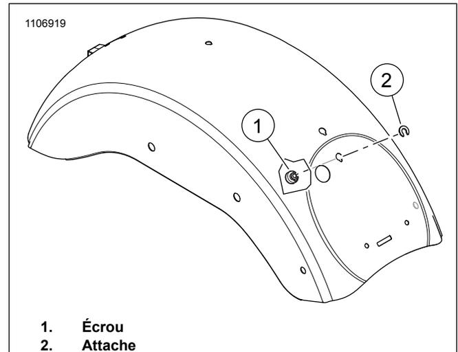
Figure 1. Écrou de selle du garde-boue (classique)
