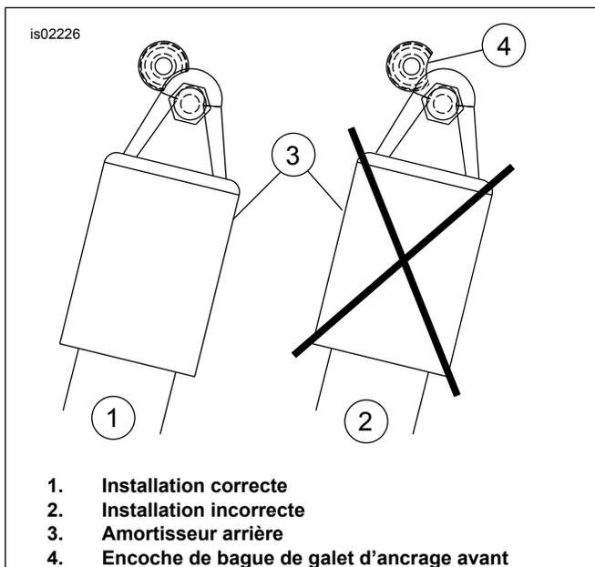
Figure 4. Position de l'encoche de galet d'ancrage avant
