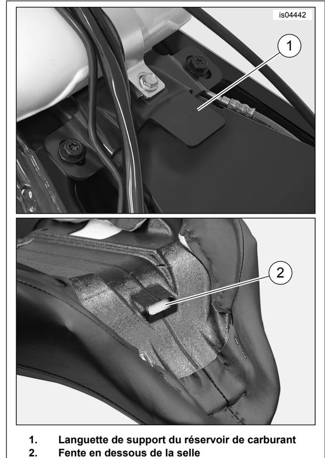
1. Languette de support du réservoir de carburant
