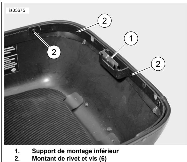
Figure 3. Installer le support de montage inférieur
