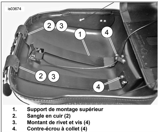
Figure 2. Installer le support de montage supérieur
