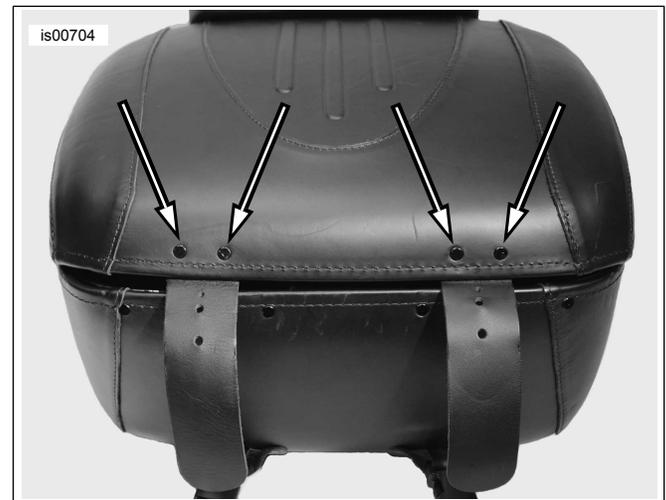
Figure 1. Emplacement des rivets de l'équipement d'origine
