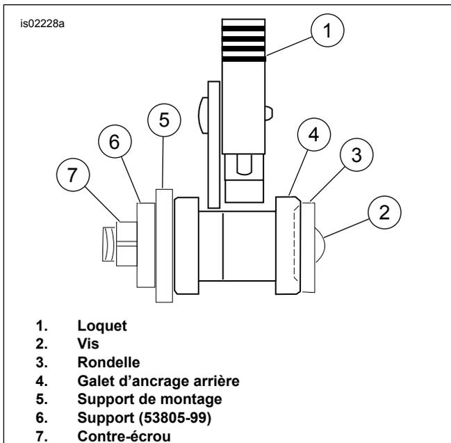
**Figure 6. Alignement de loquet de galet d'ancrage arrière**
