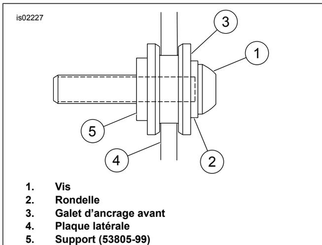
Figure 3. Plaque latérale et galet d'ancrage avant complètement engagés
