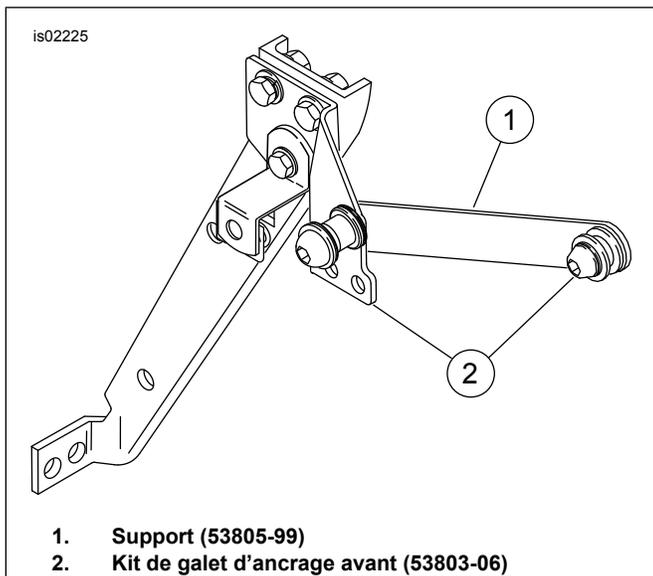
Figure 2. Kit de galet d'ancrage avant et support
