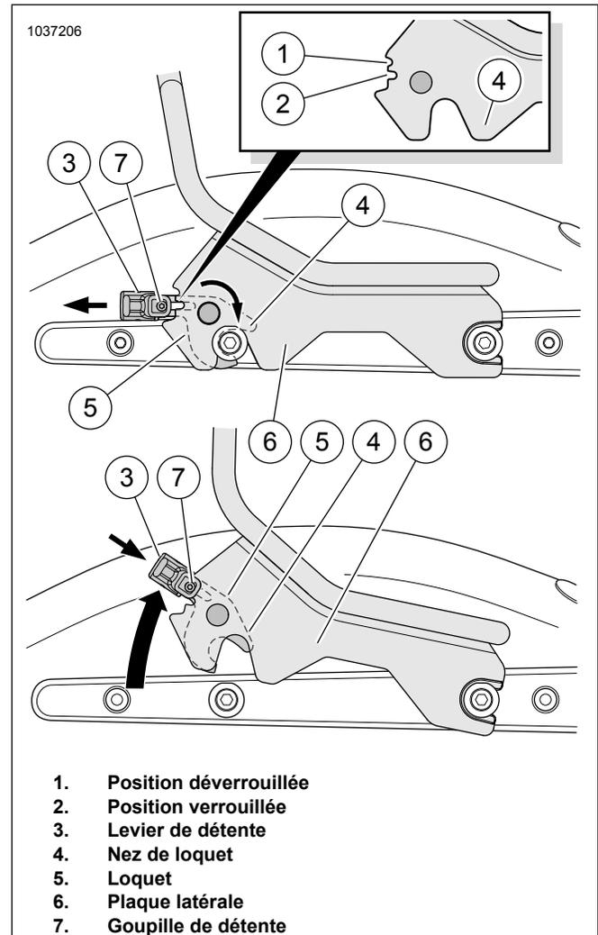
Figure 1. Dépose de l'accessoire amovible
