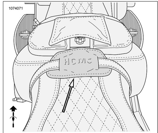
Figura 1. Tampa do botão do ajustador instalada
