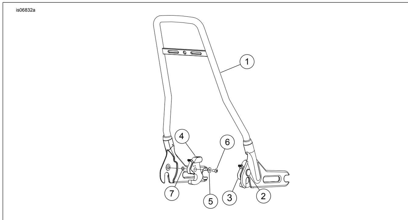
Figura 3. Peças de reposição: Conjunto de sissy bar removível e suporte traseiro da placa de licença do veículo
