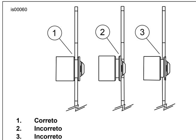
Figura 2. Encaixe da ranhura do montante no ponto de suporte
