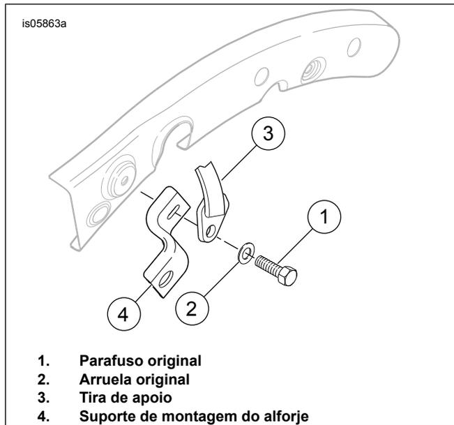
Figura 1. Remova e instale a tira de apoio
