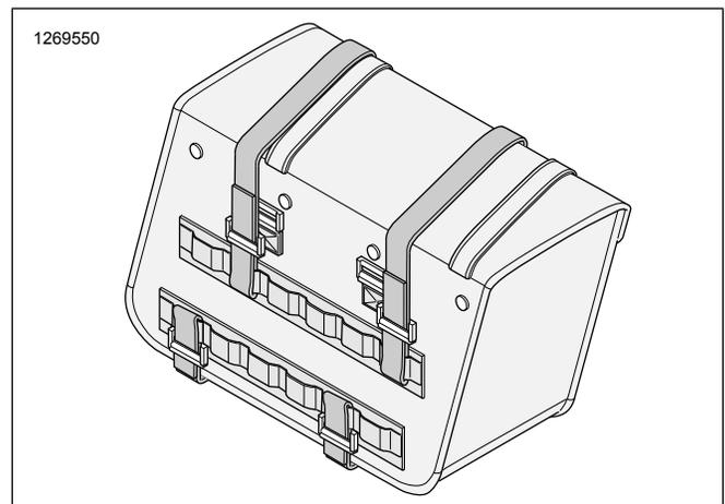
Figura 2. Fixar as fitas de velcro (típico)
