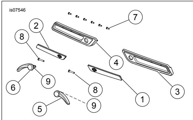
Figura 2. Peças de reposição: Kit da tampa da dobradiça e da alavanca
