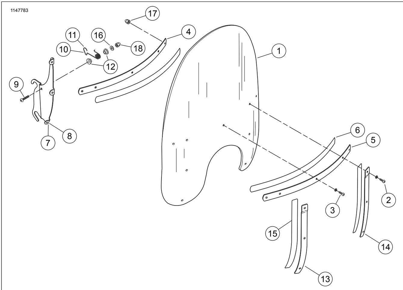
**Figura 1. Peças de reposição: Montagem do pára-brisa**
