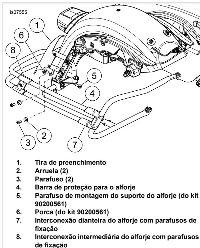
Figura 2. Instalação da tira de preenchimento ranhurada
