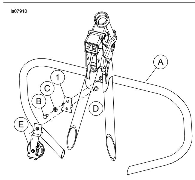
Figura 1. Peças de reposição: Kit do adaptador do suporte da buzina
