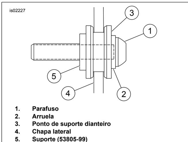
Figura 3. Chapa lateral e ponto de suporte dianteiro totalmente encaixados
