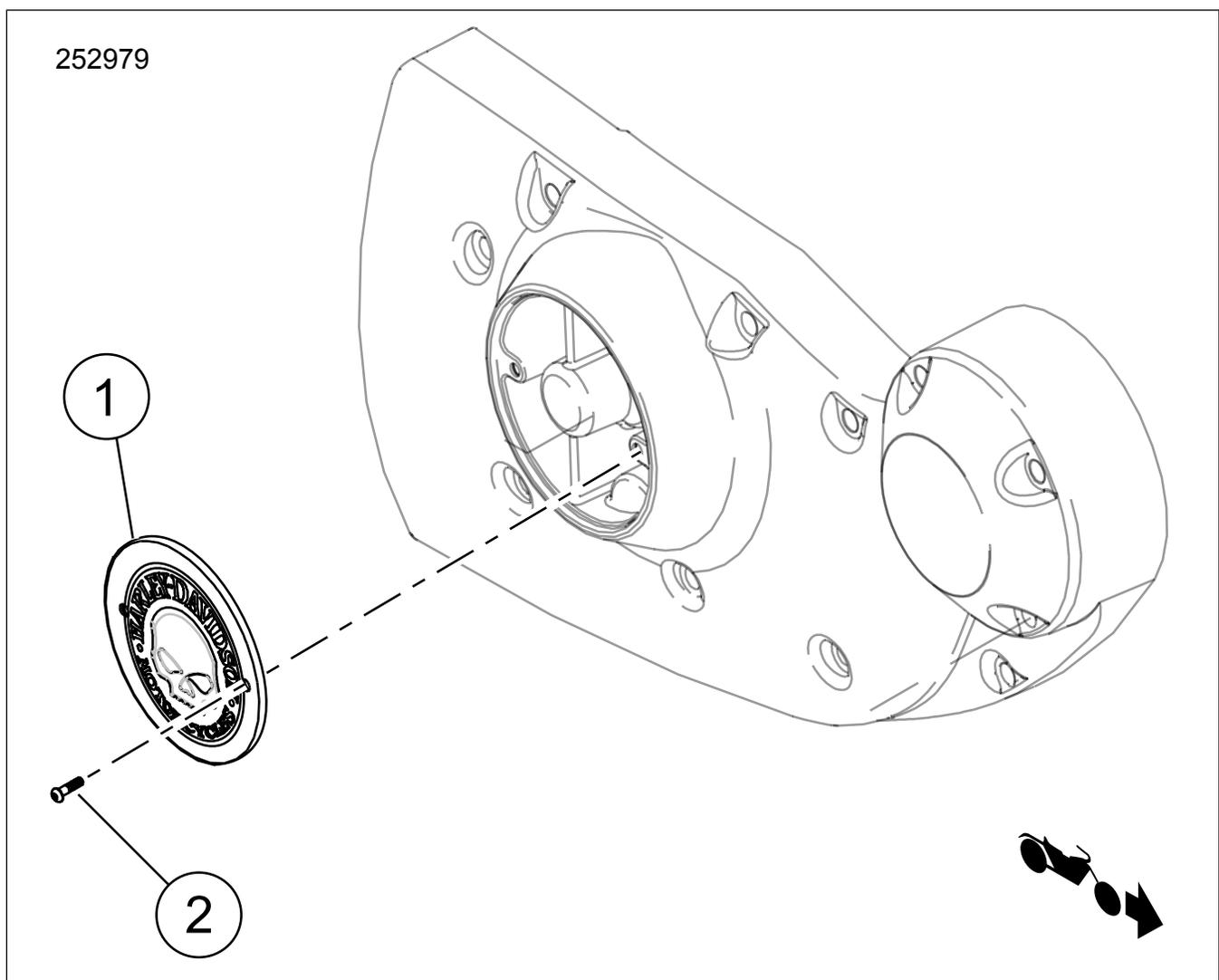
Figura 1. Conteúdo do kit: Componentes da cobertura do temporizador
