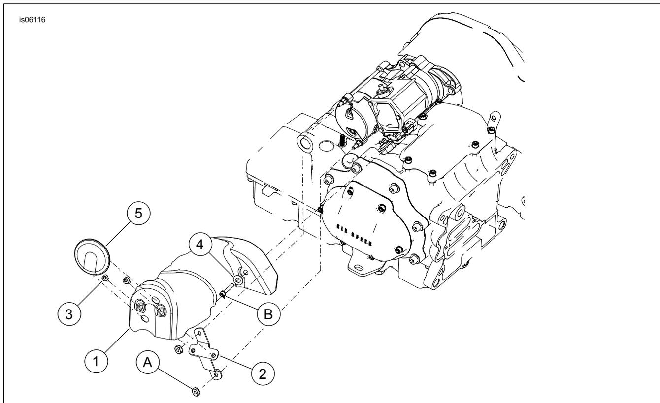
**Figura 4. Parti di ricambio: Coperchio del motorino di avviamento Touring**
