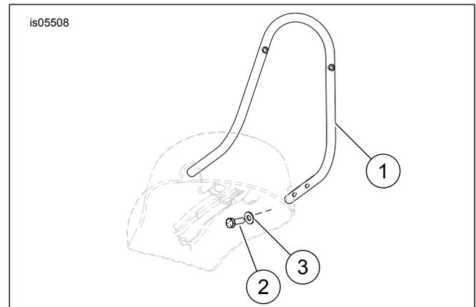
Figura 2. Parti di ricambio: Schienalino del sellino del passeggero
