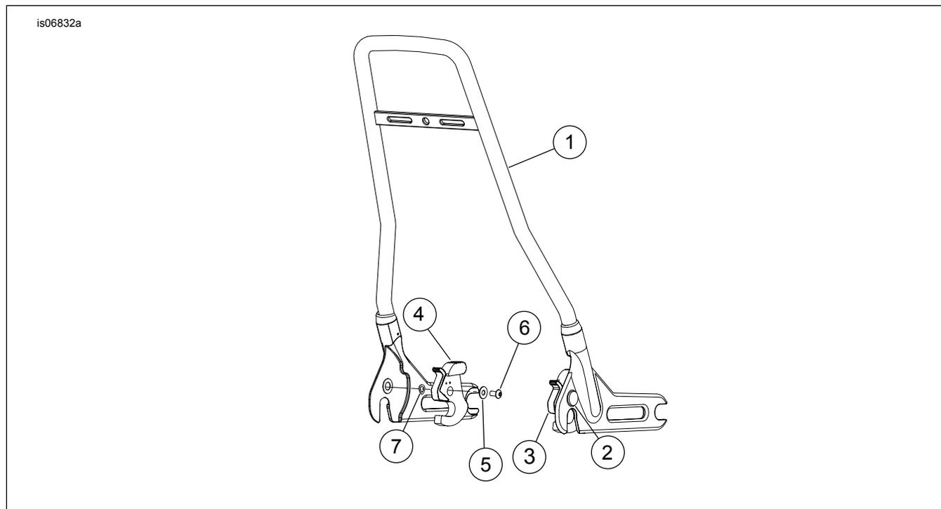
Figura 3. Parti di ricambio: Schienale e staffa posteriore della targa rimovibili
