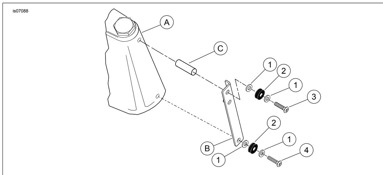
**Figura 2. Parti di ricambio: kit bulloneria di ancoraggio**
