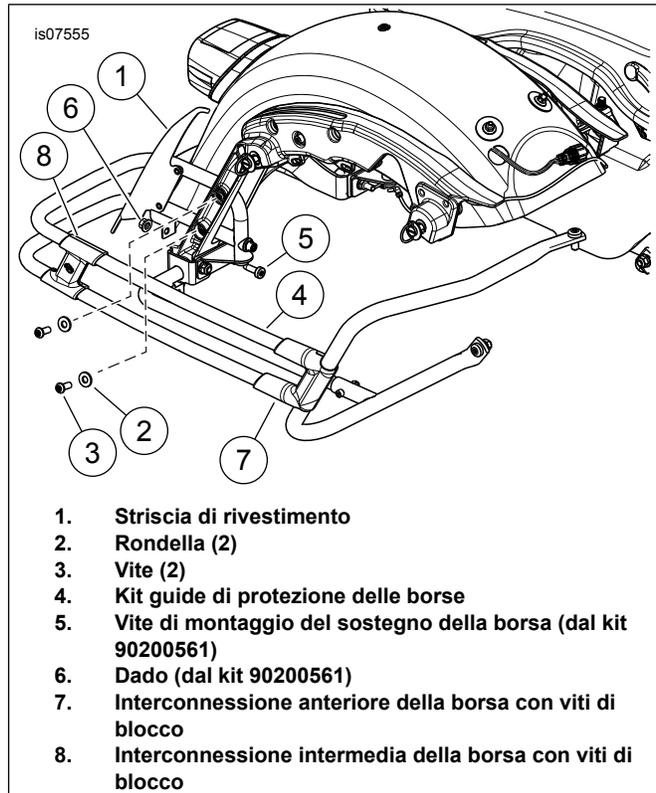
Figura 2. Installazione della striscia di rivestimento con sfinestrature
