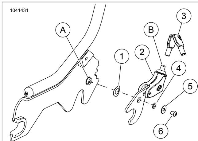
**Figura 2. Parti di ricambio, kit chiusura di blocco rimovibile**
