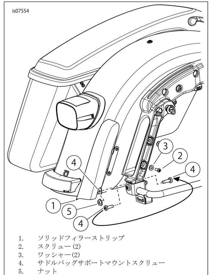
図1. ソリッドフィルーストリップの取り付け
