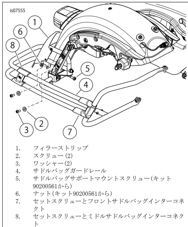
図2。スロットフィラーストリップの取り付け
