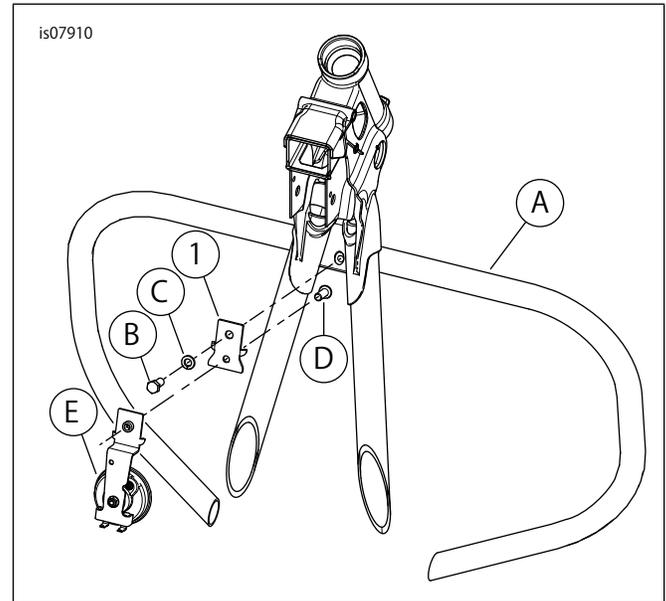
図1. 交換用パーツ:HornBracketAdapterKit (ホーンブラケットアダプターキット)
