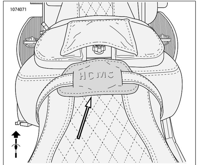
图1。已安装调节器旋钮盖
