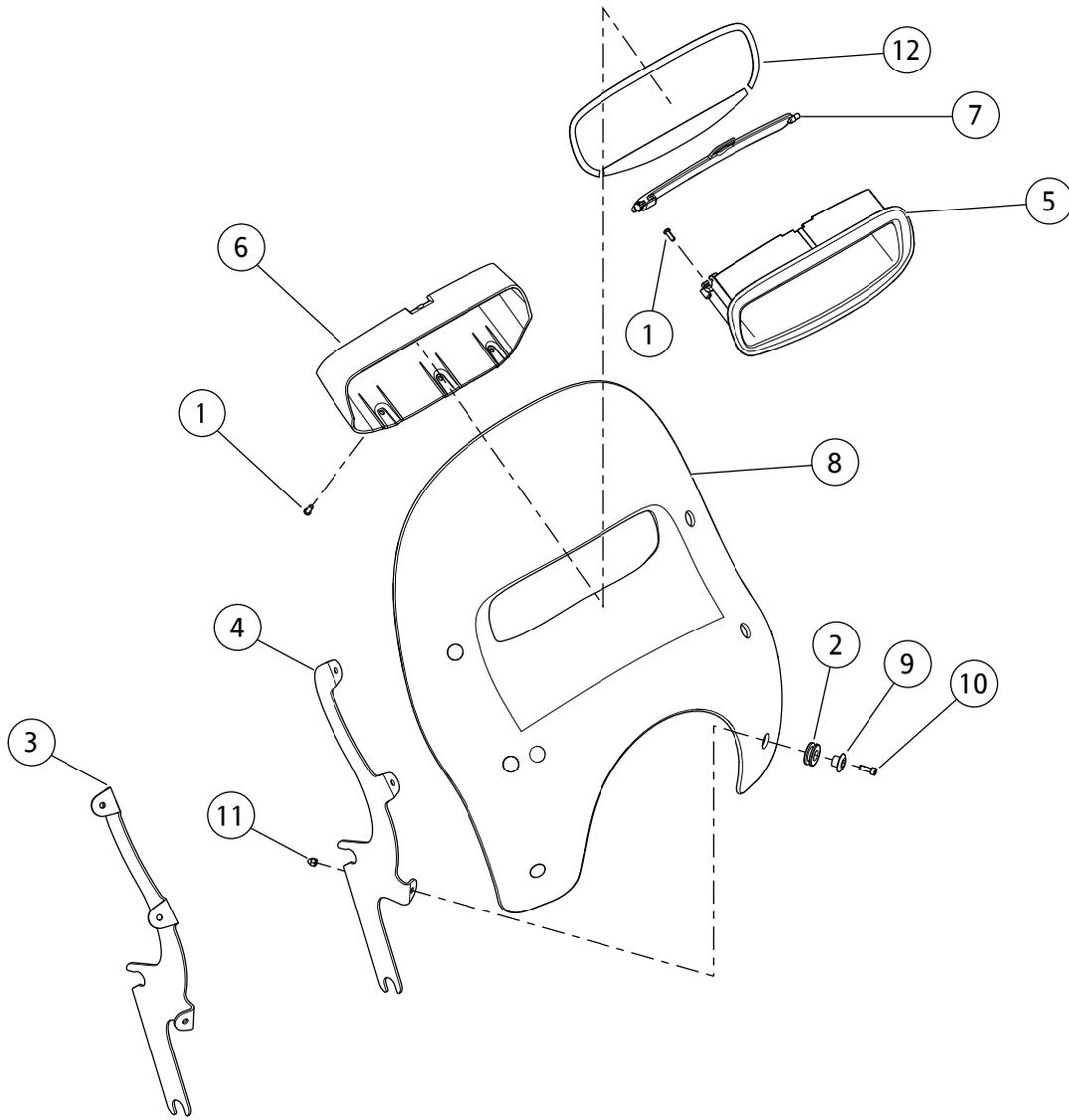
图1。维修零件：通风式可拆卸挡风玻璃
